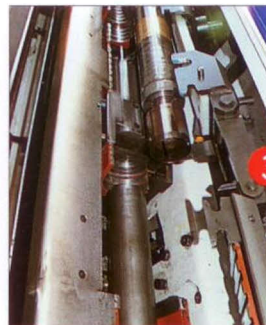
3 Il sistema a doppio spingibarra consente di ridurre la lunghezza del caricatore indipendentemente dalla lunghezza dello spingibarra.
