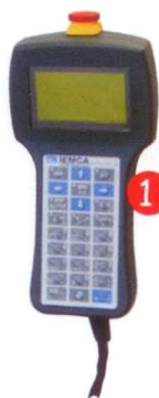
1 Il pannello operatore permette di gestire facilmente la programmazione del caricatore
