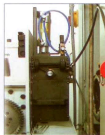
5 Il dispositivo portaboccola permette una maggiore centratura della barra e riduce al minimo le vibrazioni.
